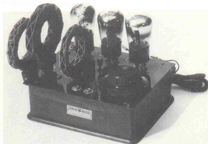
Bild 4. Typisches Dreiröhrengerät der unteren Preisklasse (Sammlung Gerbig). Nur die Rückkopplungsspule war schwenkbar, die Antennenspule konnte durch Umstecken zwischen zwei Buchsenpaaren fest oder lose mit der Abstimmungsspule gekoppelt werden.
